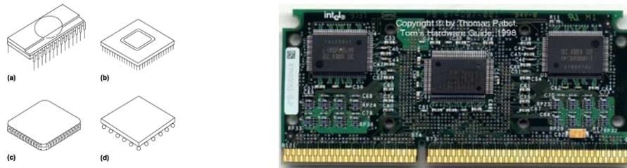
Figure 1. Premiers niveaux de packaging microélectronique.
