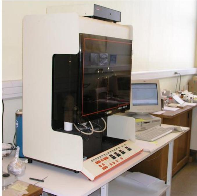
Figure 3. Dispositif expérimental de mesure de sorption d'azote
