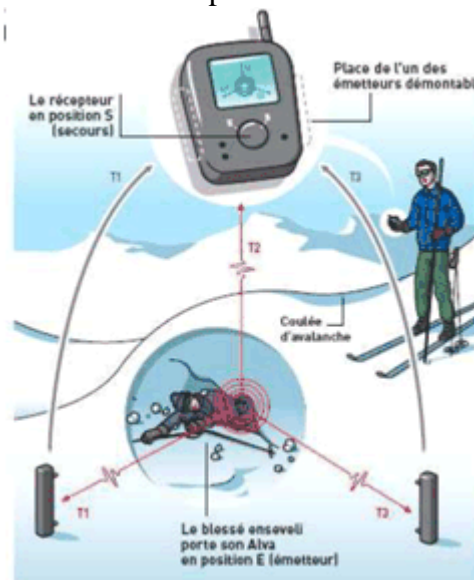
Figure I. 20: Détection de personnes ensevelie sous la neige par le système ALVA.
