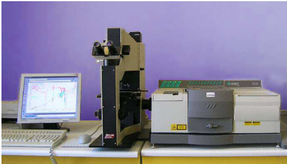
Fig. 4.6 Spectromètre FTIR utilisé pour réaliser les tests d'herméticité
