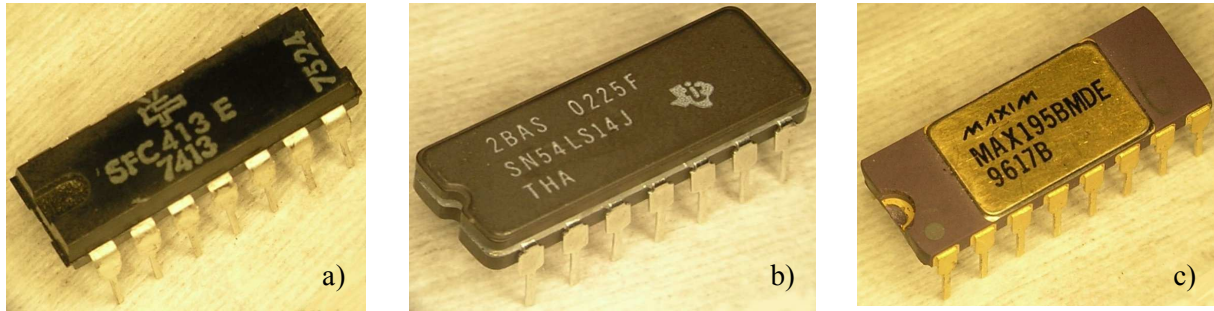
Fig. 1.7 Exemples de boîtiers électroniques : a) boîtier plastique – b) boîtier céramique – c) boîtier céramique-métal
