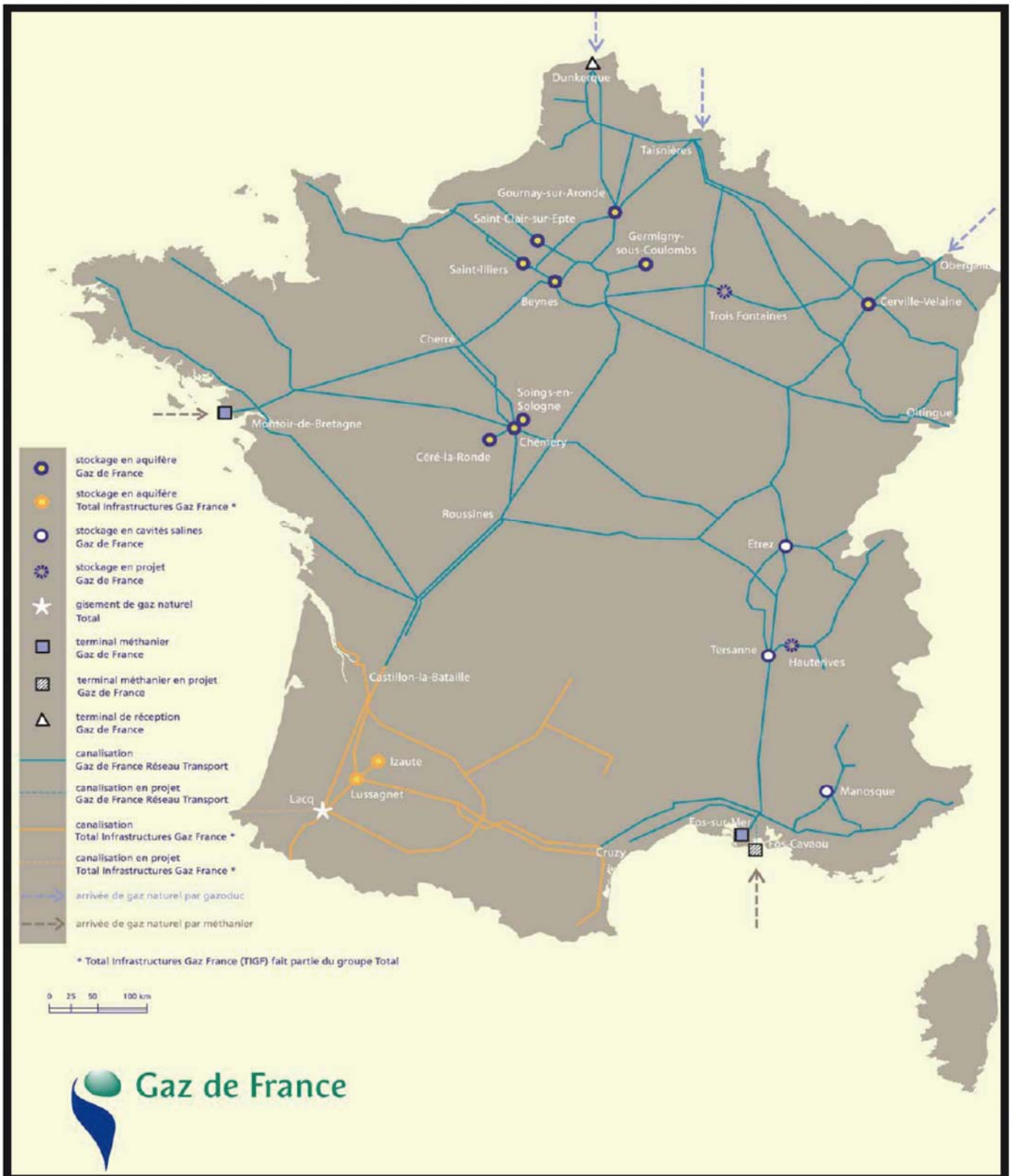
Figure 4.1: Le système de transport, les stockages et les terminaux méthaniers en France (Source: Gaz de France, 2006).
