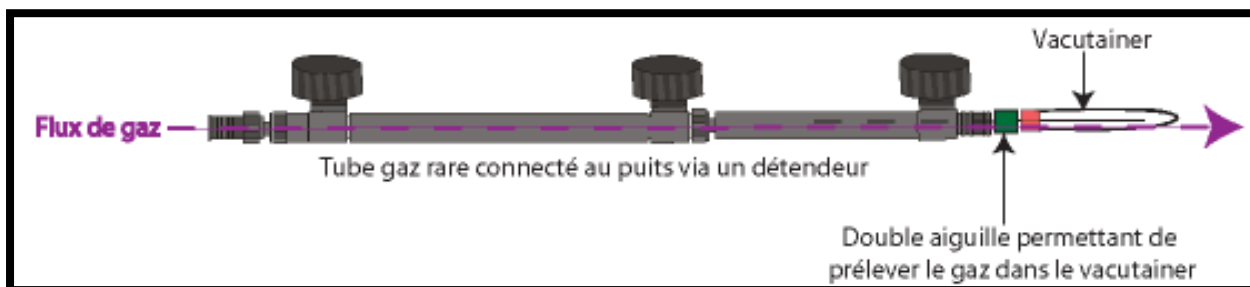
Figure A.3: Prélèvement de gaz de puits dans un vacutainer, à l'aide d'une double aiguille.
