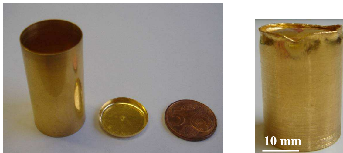
Figure III.8 : Capsule en or utilisée pour la synthèse des suspensions. A gauche, capsule et chapeau avant soudure (la pièce donne l'échelle). A droite, capsule après soudure du chapeau.
