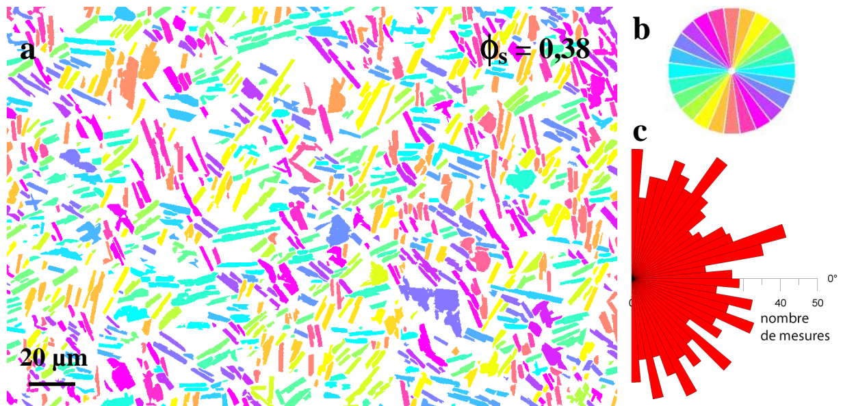
Figure III.12 : Orientations individuelles des cristaux d'une suspension non déformée contenant \phi_s = 0,38 (figure III.10). (a) Cristaux colorés suivant leurs orientations. (b) Rose de couleurs des orientations (c) Rose des directions des orientations individuelles des cristaux.
