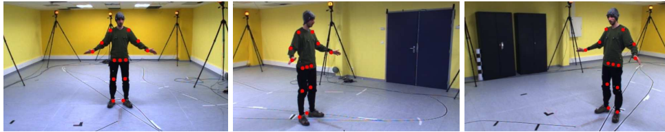
FIG. IV.2 – Reprojection des articulations calculées par le système de HMC commercial dans les images acquises (en rouge).
