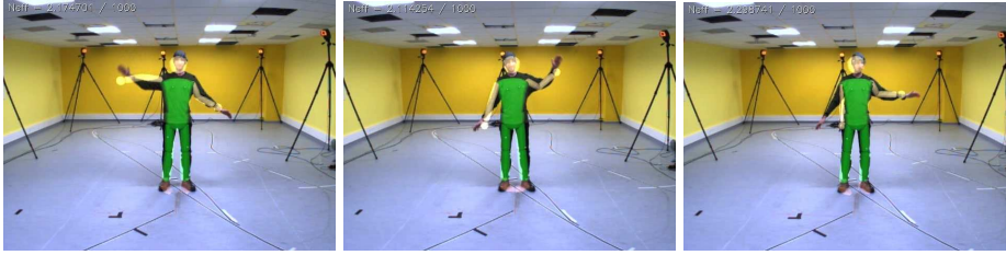
FIG. IV.6 – Suivi du sujet exploitant les mesure sil et sil2 . Le suivi des bras est plus satisfaisant, mais encore instable lorsque ceux-ci se rapprochent du corps.
