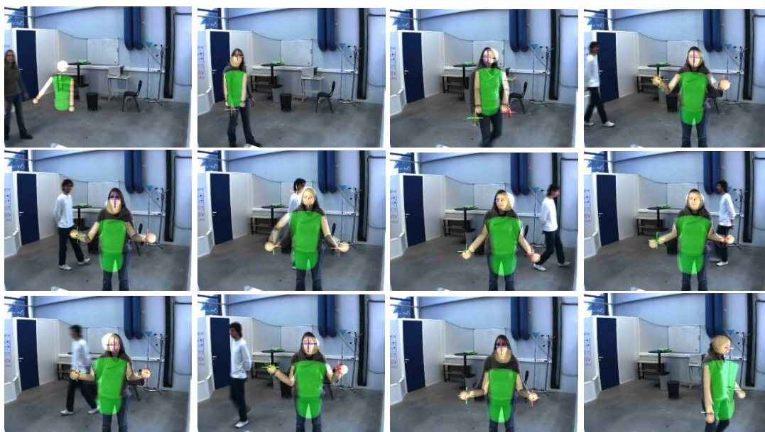
FIG. V.7 – Suivi par vision stéréoscopique sur un deuxième sujet lisant un livre. Le sujet est en partie occulté par la table.
