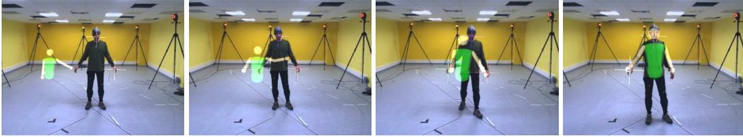
FIG. IV.13 – Déroulement de la stratégie CONDENSATION exploitant les mesures  $dist\_peau$ ,  $dist$  et  $blobs$  avec 1000 particules. L'initialisation est volontairement incorrecte. Le filtre parvient cependant à raccrocher la cible après quelques images.
