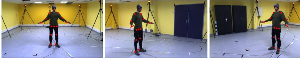
FIG. IV.2 – Reprojection des articulations calculées par le système de HMC commercial dans les images acquises (en rouge).
