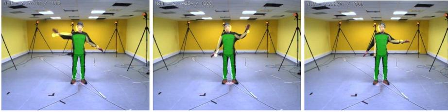
FIG. IV.6 – Suivi du sujet exploitant les mesure  $sil$  et  $sil2$ . Le suivi des bras est plus satisfaisant, mais encore instable lorsque ceux-ci se rapprochent du corps.
