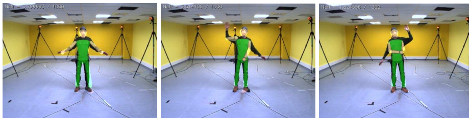
FIG. IV.5 – Suivi du sujet avec pour seule mesure la segmentation de la silhouette ( sil ). Au fur et à mesure du suivi, les bras ont tendance à se positionner devant ou derrière le corps.
