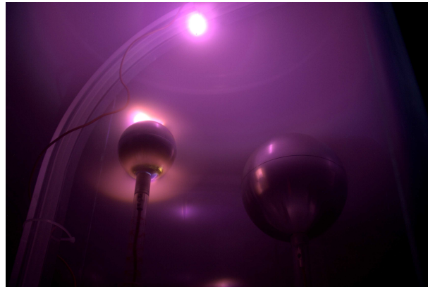
FIG. C.3 – Petite boule configurée en mode Uranus, nous voyons la formation d’un ovale auroral du côté opposé au “Soleil”. La buse est en haut de la photo.
