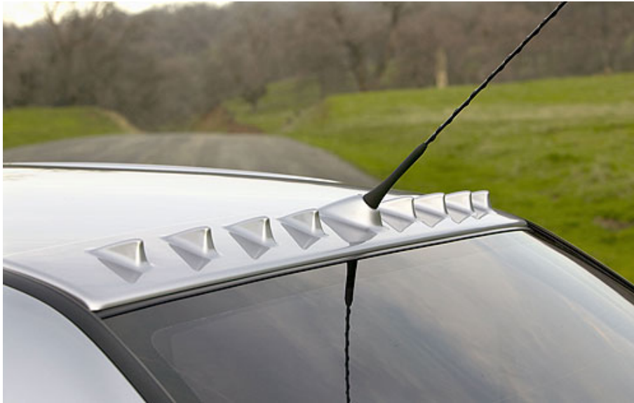
FIGURE 1.4 – Générateurs de vortex placés sur une Mitsubishi-Lancer-Evolution-IX
