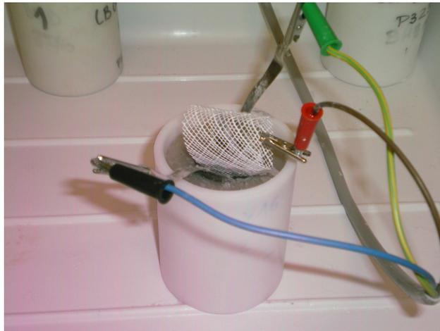
Fig. II.12 : Cellule ouverte de test en cyclage électrochimique
