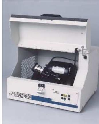
Fig. II.1 : Photographie du broyeur énergétique Spex 8000<sup>®</sup>
