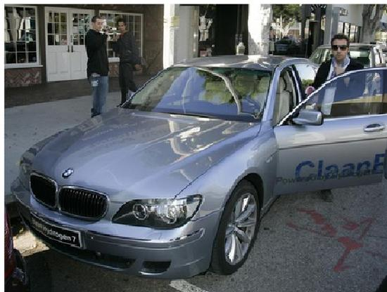
*Fig. I.23 : Photographie de la BMW HYdrogen 7, utilisant l'hydrogène comme carburant (stocké sous forme liquide)*
