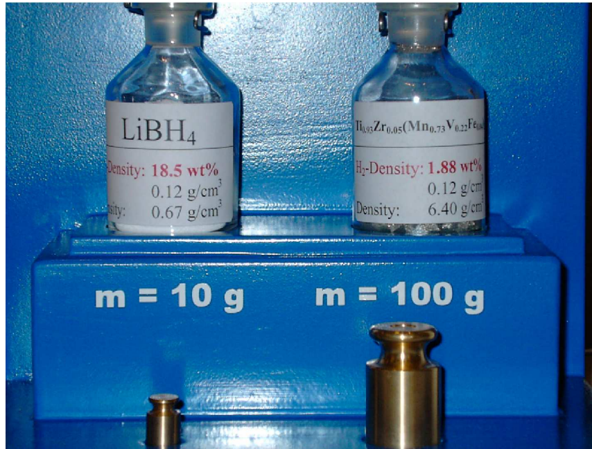
Fig. I.5: Photographie prise lors du 16 ème World Hydrogen Energy Conference en juin 2006 à Lyon, illustrant les différences de capacités massiques et volumiques entre LiBH 4 et un hydrure métallique de type AB 2 H n
