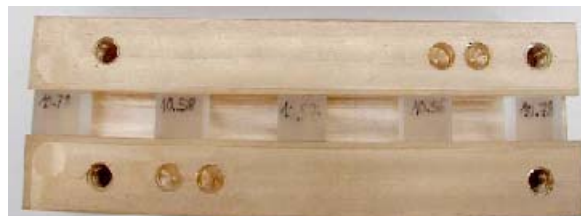
Figure 49: Guide d'ondes rectangulaire avec inserts diélectriques.
