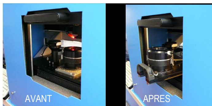
Figure 11 : Accès à la chambre d'ablation avant et après l'installation du rail
