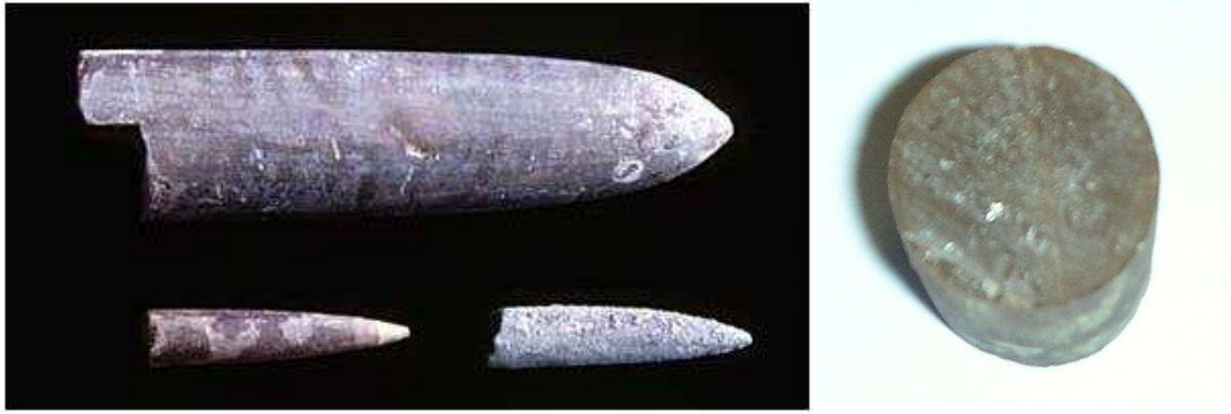
Figure 3 - 4 : Rostre de Bélemnite du crétacé échantillons entiers (gauche) et échantillon ayant servi pour les mesures de la calibration (droite).
