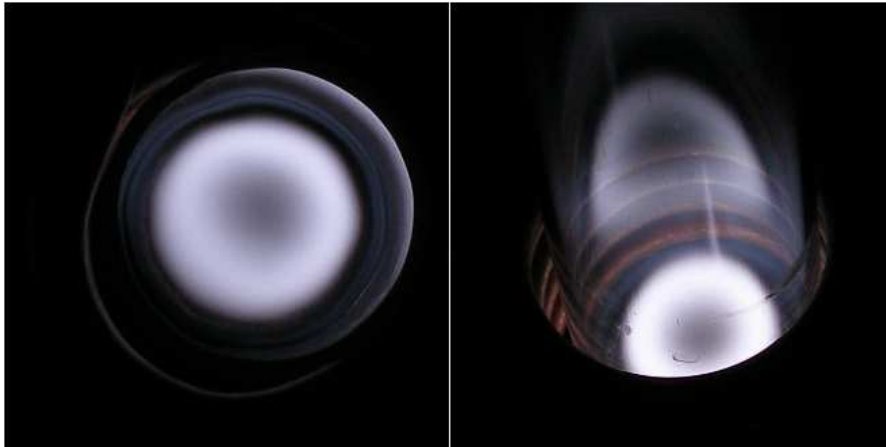
Figure V-12 : torche d'analyse avec un plasma fonctionnant en mode annulaire à basse puissance.
