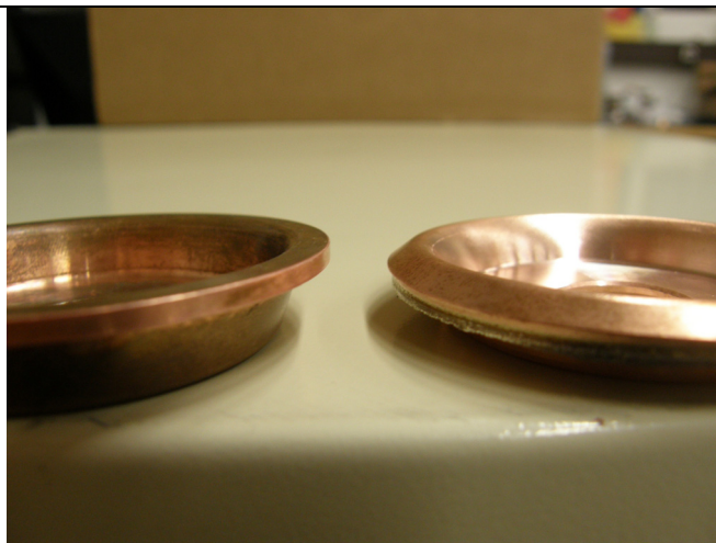
Figure 6.10. Déformation plastique du capot brasé avec la brasure CB4 (à droite). Le capot non déformé est présenté à gauche
