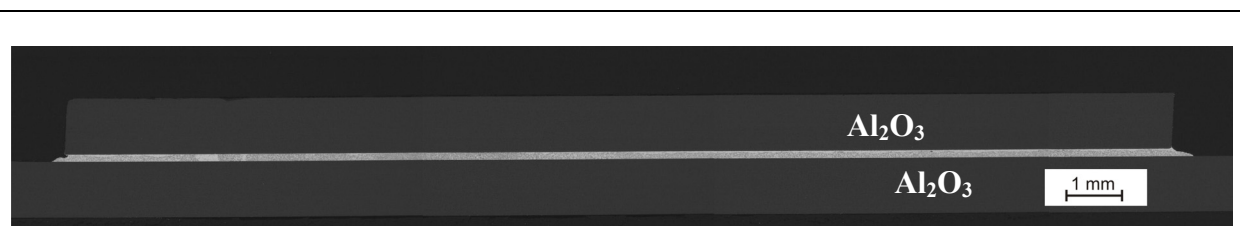
Figure 5.10. Section d'assemblage homogène réalisé avec 10,0 % en poids de Ti
