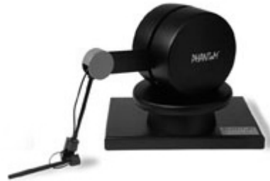
Figure 2.1 le Phantom de Sensable Technologies, qui existe en version bureautique
