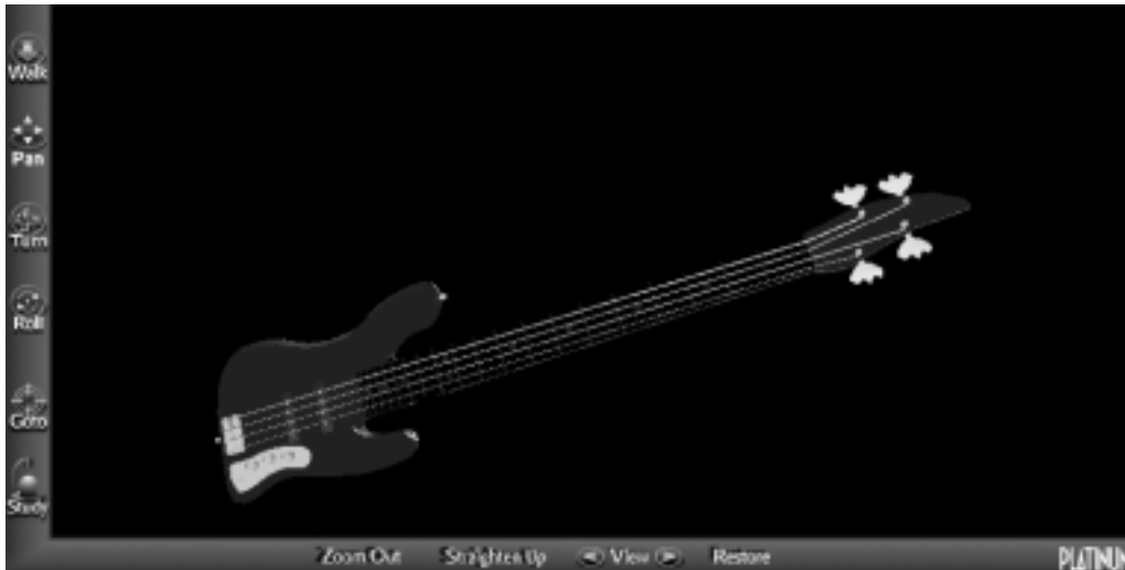
Figure 2.4 WorldView Platinum , visionneuse VRML (navigation possible au joystick). Le pointeur de la souris change de rôle en fonction des outils que l'on sélectionne sur la palette à gauche.
