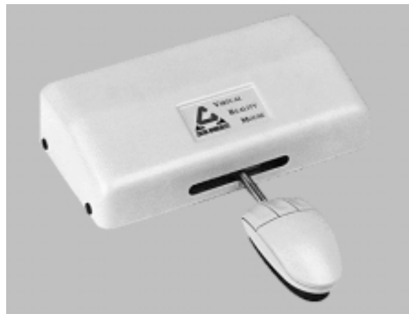
Figure 2.2 souris à retour de force : la Feelit de Immerse Corporation et la Virtual Reality Mouse de Control Advancements
