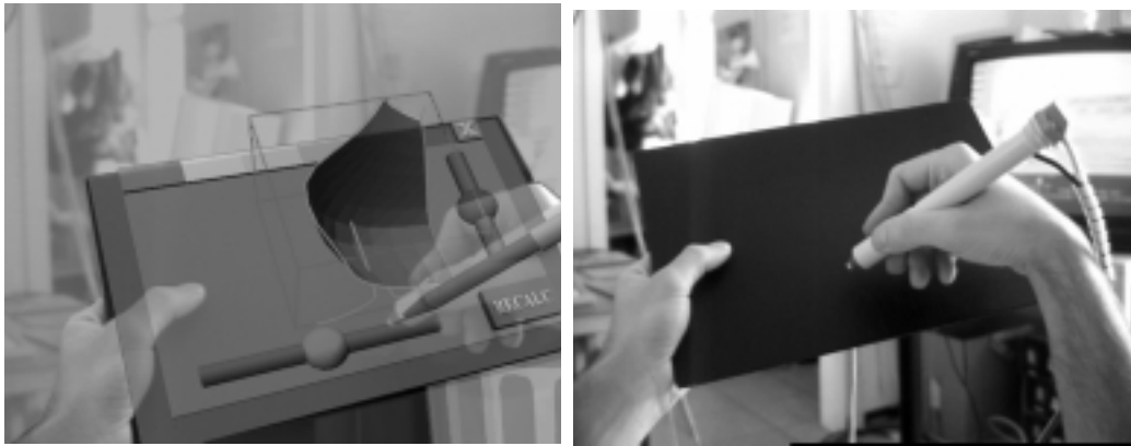
Figure 5.7 le PIP, système d'interaction entièrement basé sur une palette bi-manuelle
