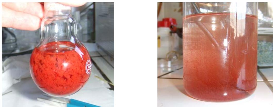
**Figure V.8 :** Clichés d'un composé obtenu par la méthode des micelles inverses avant et après ajout d'éther diéthylique
