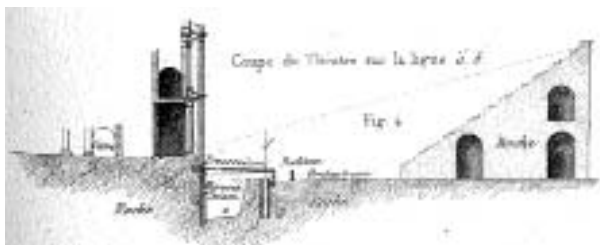
Fig. 254. Coupe sur le théâtre d'Arles montrant le « podium ». Dessin de D. HENRY, loc. cit., 1837.
