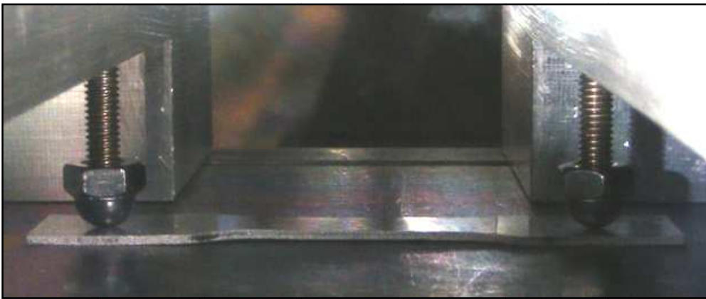
Figure 69 : Système de bridage des éprouvettes de traction
