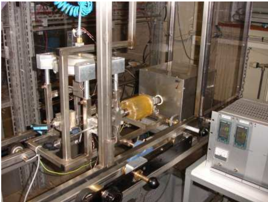
Figure 4. Vanne de décompression automatisée sur un autoclave à joints froids et trempe rapide (ISTO). Pression maximale: 2000 bars; Température maximale: 875°C; Milieu de pression: argon, argon + hydrogène ou eau.
