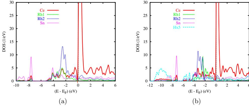
**Figure 6.5:** Calculs non-magnétiques : Densités d'états projetées sur chacun des sites dans CeRhSn (a) et CeRhSnH<sub>1,33</sub> (b). Les PDOS des sites de H sont artificiellement multipliées par 5 pour améliorer la présentation.
