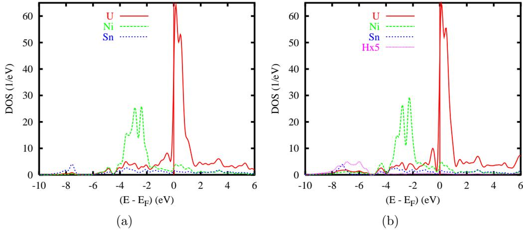
**Figure 7.2:** Calculs non-magnétiques : tracés PDOS pour U<sub>2</sub>Ni<sub>2</sub>Sn (a) et U<sub>2</sub>Ni<sub>2</sub>SnH<sub>2</sub> (b).
