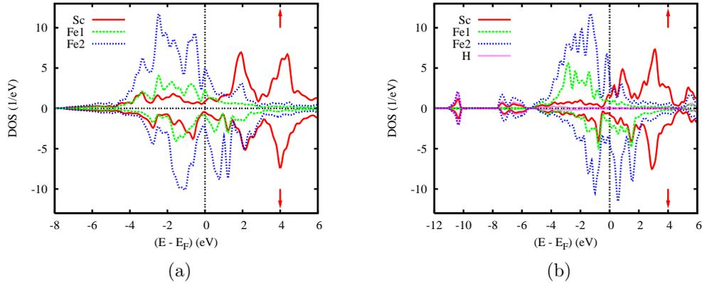
**Figure 4.6:** Calculs magnétiques : Densités d'états projetées sur chacun des sites et pour chacune des deux orientations possibles du spin ( $\uparrow$  et  $\downarrow$ ) dans ScFe<sub>2</sub> (a) et ScFe<sub>2</sub>H<sub>2</sub> (b).
