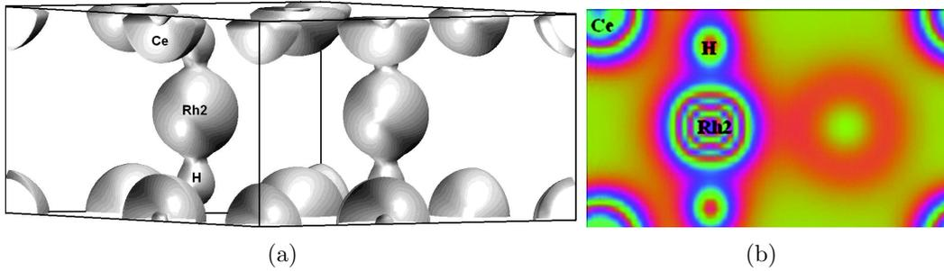
**Figure 6.4:** Cartographie de la densité électronique du modèle  $\text{CeRhSnH}_{1,33}$  : isosurfaces de valeur 0,33 (a) et projection des isosurfaces suivant un plan perpendiculaire à l'axe  $b$  et traversant les atomes, Rh2 et H (b). Les dessins sont faits par le logiciel VMD [136].
