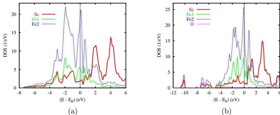
**Figure 4.4:** Calculs non-magnétiques : Densités d'états projetées sur chacun des sites dans ScFe<sub>2</sub> (a) et ScFe<sub>2</sub>H<sub>2</sub> (b).
