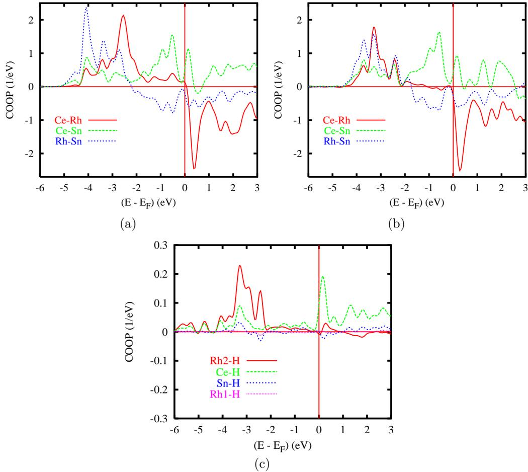
**Figure 6.6:** Liaisons chimiques dans une configuration non-magnétique : COOP des interactions métal-métal de CeRhSn (a), CeRhSnH<sub>1,33</sub> (b) et des liaisons H-métal de CeRhSnH<sub>1,33</sub> (c).
