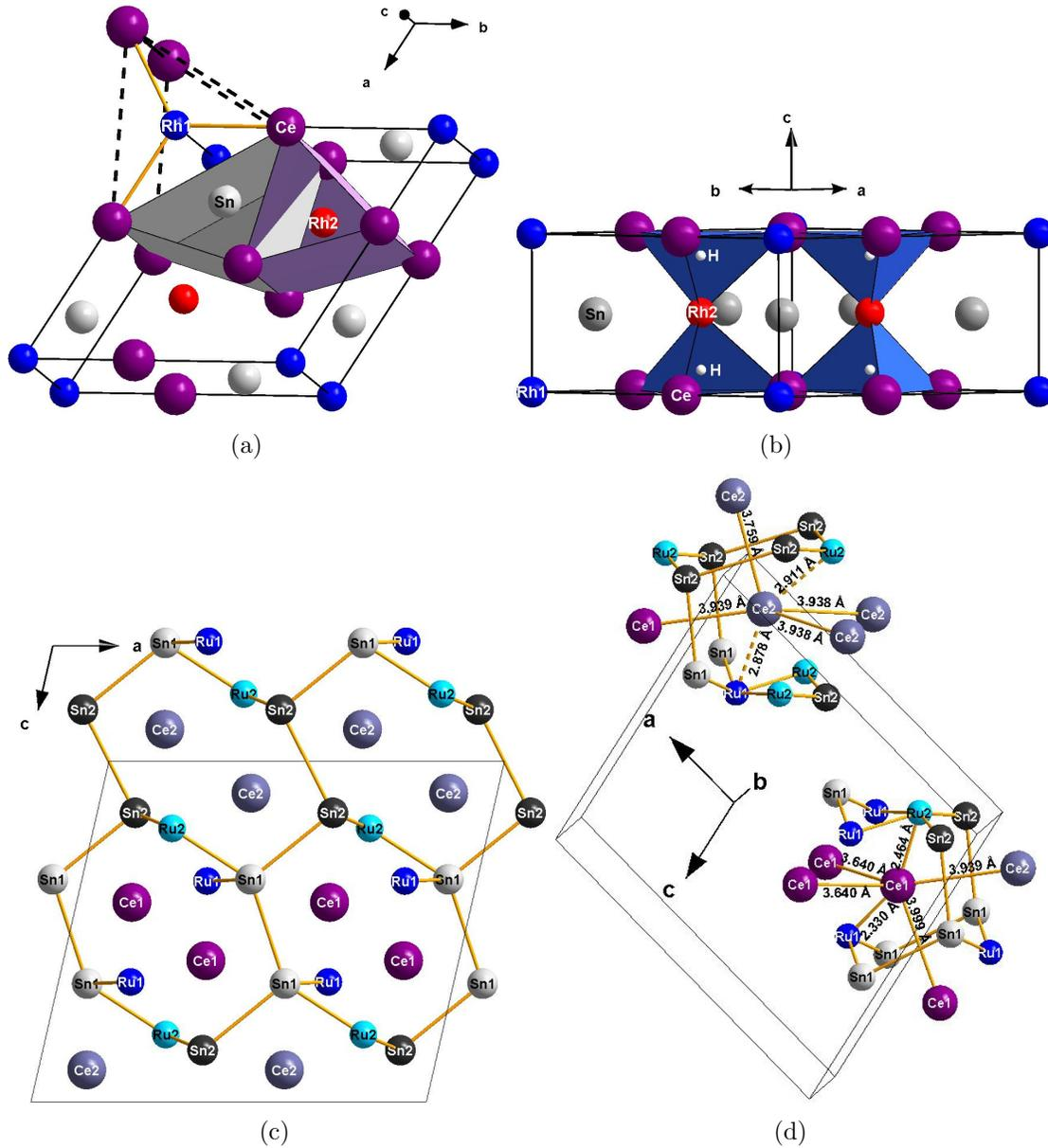
**Figure 6.2:** Structures cristallographiques de : (a) CeRhSn mettant en relief les prismes trigonaux  $[Ce_6]$  qui s'empilent pour former la maille, (b) CeRhSnH<sub>1.33</sub> montrant les sites tétraédriques  $[Ce_3Rh_2]$  où se trouvent les atomes H, (c) CeRuSn projeté suivant l'axe monoclinique *b* et mettant en relief les réseaux tridimensionnels  $[RuSn]$  et (d) CeRuSn montrant les sphères de coordination de Ce1 et Ce2 (cf. le texte pour de plus amples détails).
