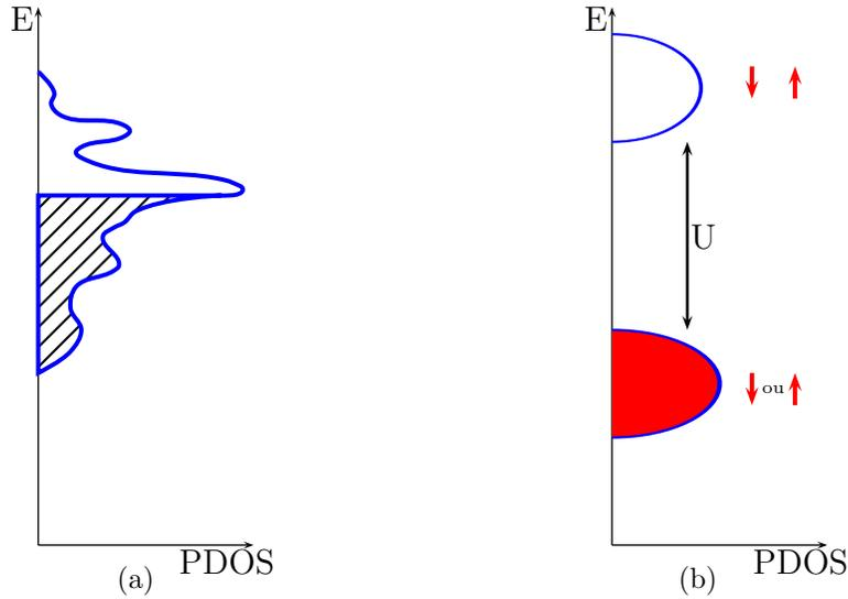
**Figure 6.3:** Schéma de principe mettant en relief les tracés des densités d'états obtenus de : (a) un modèle utilisant LDA, où la corrélation électronique est faible, et (b) un modèle utilisant LDA+U, où la corrélation est forte.
