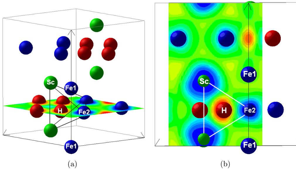
**Figure 4.3:** ScFe<sub>2</sub>H<sub>2</sub> : cartographie de la fonction de localisation électronique (ELF) projetée suivant les plans  $z = 0,25$  (a) et  $x = 0,77$  (b). Tous les atomes du sous-réseau Fe1 sont marqués afin de les différencier des atomes Fe2. L'environnement tétraédrique [Sc<sub>2</sub>Fe<sub>2</sub>] de l'hydrogène est montré par des lignes pleines liées entre elles.
