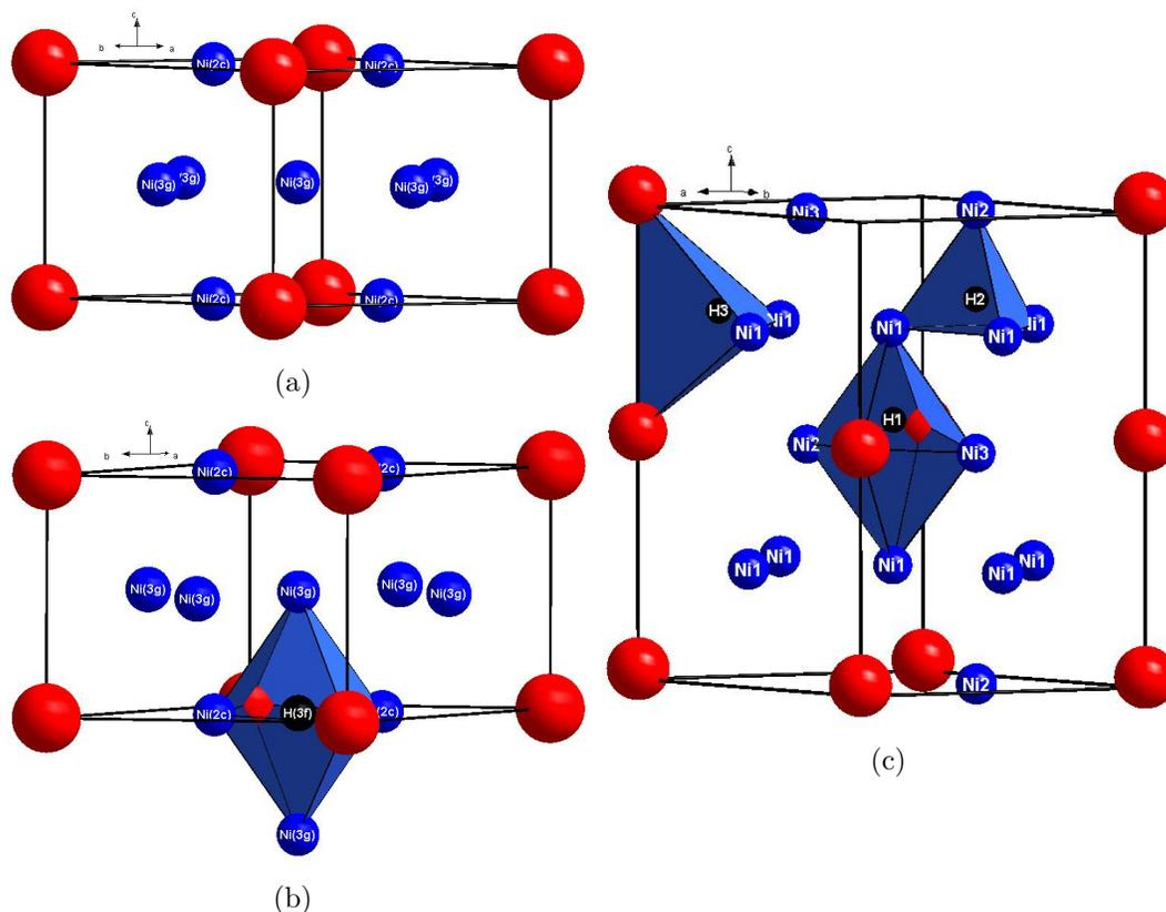
**Figure 5.1:** Structures cristallographiques de : LaNi<sub>5</sub> (a), LaNi<sub>5</sub> en mettant en relief le site octaédrique 3f de l'insertion de H (b) et l'hydrure β1 de composition La<sub>2</sub>Ni<sub>10</sub>H<sub>14</sub> (Z = 1) (c). Pour la structure du modèle β1, les différents sites d'insertion de l'hydrogène ainsi que leurs environnements atomiques sont mis en évidence.
