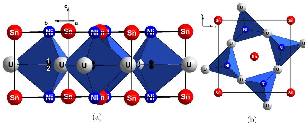
**Figure 7.1:** Structure cristallographique de  $U_2Ni_2SnH_2$  : (a) la projection met en relief les chaînes formées de pyramides trigonales suivant l'axe  $c$  ainsi que les sites 8k d'insertion de l'hydrogène numérotés par les chiffres 1 et 2; (b) montre une projection du dihydrure suivant le plan  $ab$  où les atomes U porteurs de moments magnétiques sont arrangés sous forme d'un carré.
