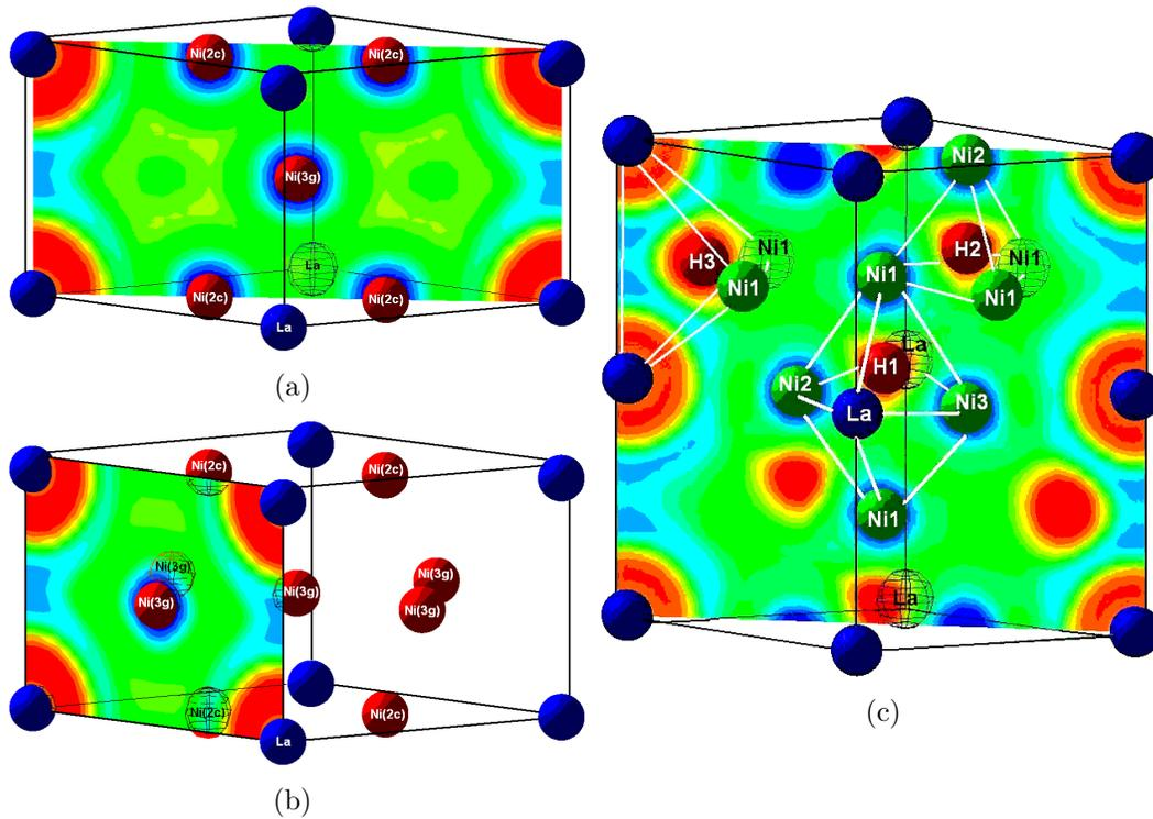
**Figure 5.3:** Cartographie de la fonction de localisation électronique (ELF) de :  $\text{LaNi}_5$  suivant les plans (1 1 0) (a) et (1 0 0) (b) et l'hydrure  $\beta_1$  suivant le plan (1 1 0) (c). Dans ce dernier cas, les environnements atomiques de l'hydrogène sont montrés par des traits pleins liés entre eux.
