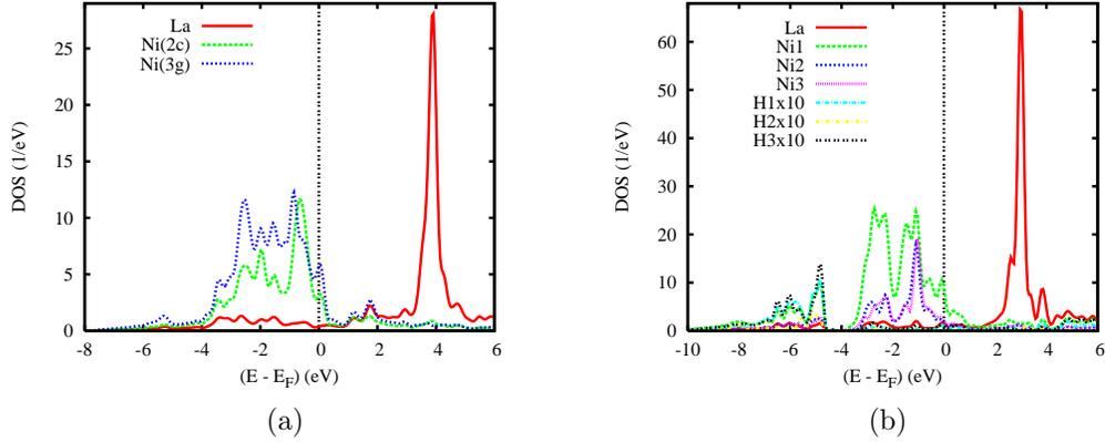
**Figure 5.4:** Calculs non-magnétiques : Densités d'états projetées sur chacun des sites dans  $\text{LaNi}_5$  (a) et son hydrure  $\beta 1$  (b). Dans le cas du modèle  $\beta 1$  les PDOS des atomes H sont artificiellement multipliés par un facteur de 10 pour une illustration plus claire.
