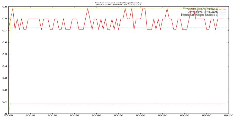
Figure 7: Simulation d'une séquence de 100 000 lettres i.i.d. équiprobables. Sont représentés, en fonction de la longueur  $n$  des préfixes, les rapports  $D_n/\log n$  (courbe oscillante), les longueurs des plus petite et plus longue branches (enveloppes inférieure et supérieure). La droites horizontales est la limite théorique commune  $1/h = 1/h_+ = 1/h_-$ .
