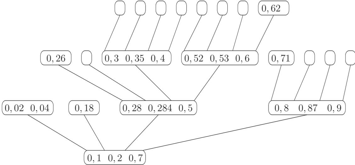
Figure 2: Insertions des clefs 0,2 ; 0,7 ; 0,1 ; 0,8 ; 0,28 ; 0,18 ; 0,284 ; 0,5 ; 0,9 ; 0,04 ; 0,52 ; 0,3 ; 0,53 ; 0,6 ; 0,02 ; 0,87 ; 0,4 ; 0,71 ; 0,35 ; 0,26 ; 0,62 dans un arbre quaternaire de recherche.
