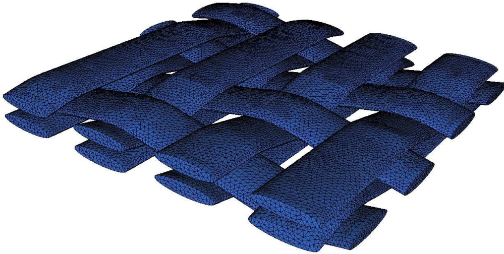
FIGURE 4.14 – Maillage EF volumique d'un renfort tissé
