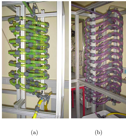
FIG. 3.3: Photos montrant les deux serpentins mélangeur-réacteur. 3.3(a) Serpentin hélicoïdal et 3.3(b) serpentins à trajectoires chaotiques.
