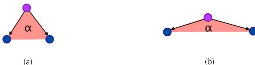
Figure 9 - Influence de l'angle  $\alpha$  entre les 2 arêtes de bords – (a) angle proche de  $180^\circ$  : faible modification de forme – (b) angle éloigné de  $180^\circ$  : modification importante de la forme locale.
