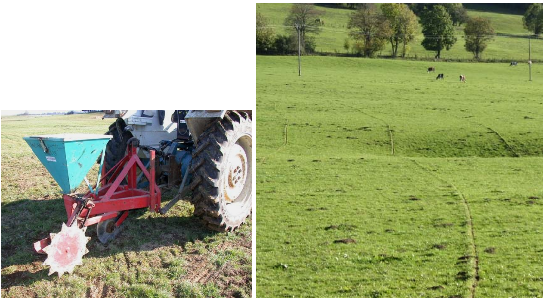
Figure 8. Photographie d'une charrue sous-solleuse (à gauche) et d'une parcelle après traitement (à droite).
