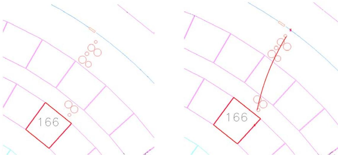
Fig. 3.1 : La reconstruction d'une trace à partir des informations délivrées par les cellules déclenchées. A gauche, les cellules déclenchées sont représentées par des cercles dont le rayon correspond à la distance entre la cellule et la trajectoire de la particule. A droite, la trace est reconstruite. Un compteur ayant enregistré un dépôt d'énergie de 166 keV est également représenté par un rectangle rouge.
