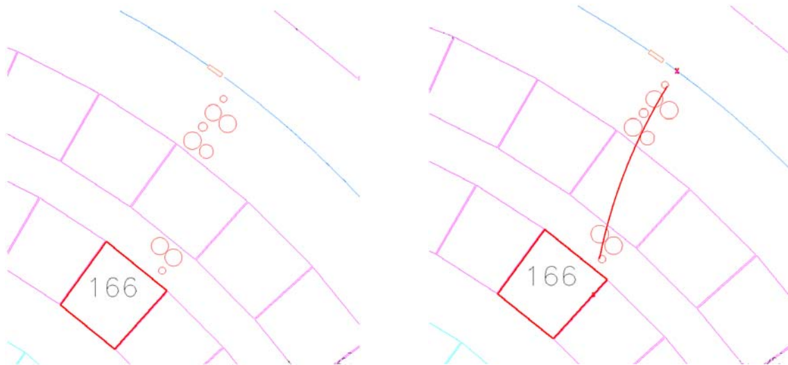
Fig. 3.1 : La reconstruction d'une trace à partir des informations délivrées par les cellules déclenchées. A gauche, les cellules déclenchées sont représentées par des cercles dont le rayon correspond à la distance entre la cellule et la trajectoire de la particule. A droite, la trace est reconstruite. Un compteur ayant enregistré un dépôt d'énergie de 166 keV est également représenté par un rectangle rouge.
