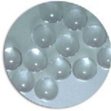
Figure 5.6 : Image de microscopie à balayage des microbilles standard de verre borosilicaté utilisées pour l'élaboration d'échantillons de référence en tomographie STIM/PIXE.
