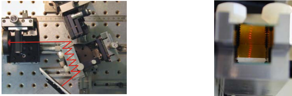
Figure 10 : Photos de dessus (a) et dans l'axe (b) du coupleur proposé pour augmenter le déplacement du faisceau réfléchi par les micro-poutres
