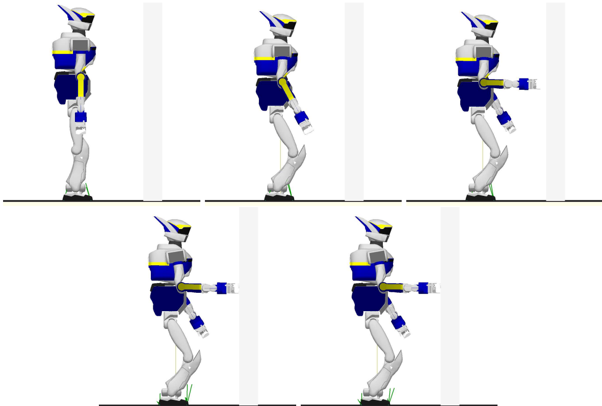
figure 5.5: Captures d'écran de simulation. De gauche à droite, le robot est d'abord tout droit, il plie ensuite ses jambes et légèrement ses bras, il plie son bras droit pour l'avoir horizontal, il avance son bras, il touche alors la poutre et enfin il reste dans cette position.
