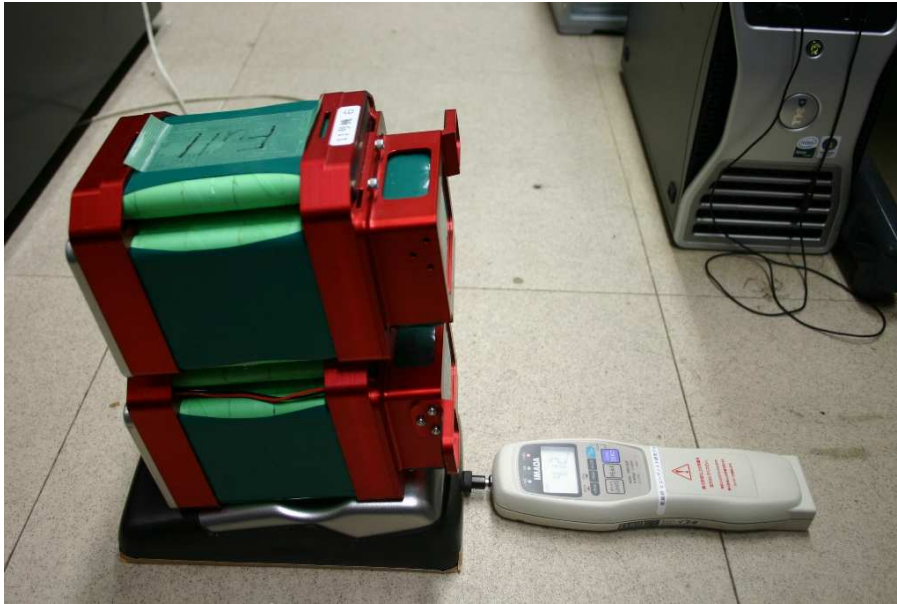
figure 5.2: Dispositif pour mesurer le coefficient de frottement statique entre le pied et le sol.
