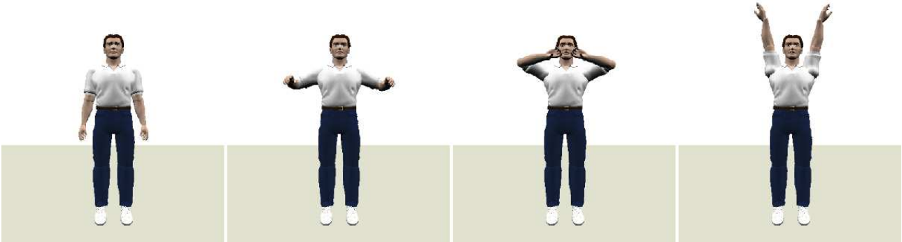
figure 3.18: Avatar humain réalisant un mouvement d'étirement des bras. Les épaules, les poignets, la hanche et les pieds sont modélisés par des articulations sphériques.
