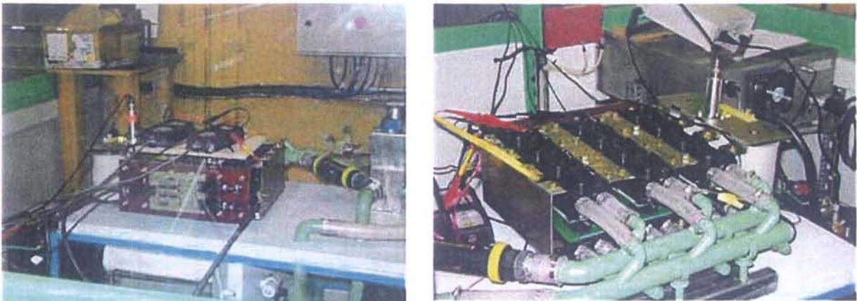
Figure I-60 : Bras d'onduleur 3 x 3.3 kV HIPO
