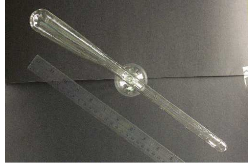
FIG. 4.2 – La nouvelle géométrie de la cible destinée à minimiser les bruits de fond et les corrections radiatives. Elle a été utilisée pour les basses énergies de E97-110 et la diffusion à 6^\circ uniquement.
