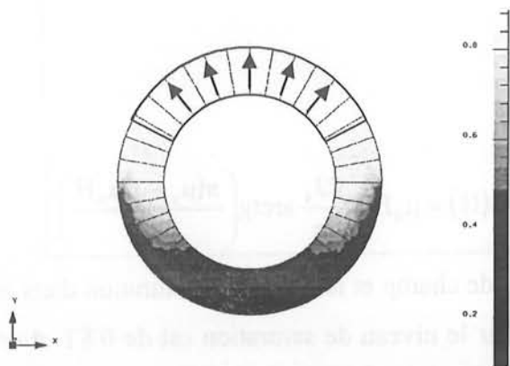
Figure 52 : Saturation (en Tesla) dans l'anneau de mumétal pour un aimant radial avec un angle d'ouverture de 125^\circ
