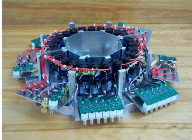
FIG. 2.25 – Photographie des moniteurs de luminosité.
