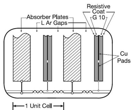
FIG. 2.15 – Représentation schématique d'une cellule du calorimètre.
