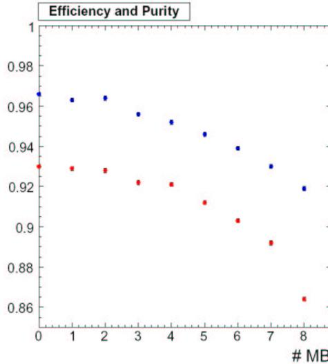
FIG. 3.2 – *Efficacité (en rouge) et pureté (en bleu) de reconstruction des traces en fonction du nombre d’événements de biais minimum ajoutés, dans des événements de production de paires de quarks top [56].*
