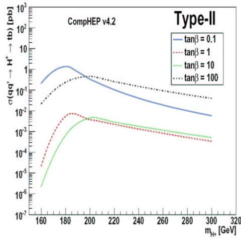
FIG. 1.13 – Section efficace de production du boson de Higgs chargé au Tevatron par annihilation de quarks, multipliée par le rapport d'embranchement du boson de Higgs chargé en  $tb$ , en fonction de la masse du boson de Higgs chargé, pour différentes valeurs de  $\tan\beta$ .
