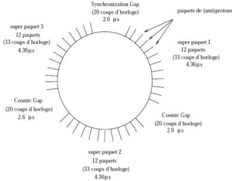
FIG. 2.3 – Structure des faisceaux dans l’anneau du Tevatron.
