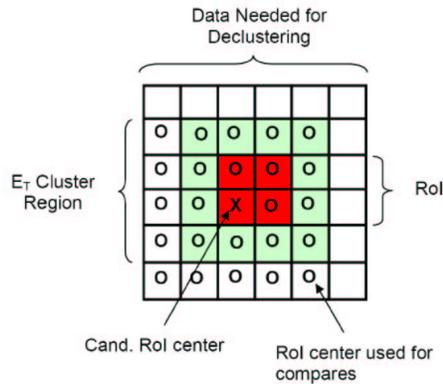
FIG. 4.2 – Schéma de l’algorithme “fenêtres glissantes” (“Sliding Windows”) dans le plan  $\eta \times \phi$ , avec une région d’intérêt de  $2 \times 2$  tours (en rouge) et un anneau de largeur 1 tour (en vert). La tour marquée d’une croix est le centre de la ROI. Chaque cercle symbolise le centre d’une ROI utilisée pour déterminer le maximum local.
