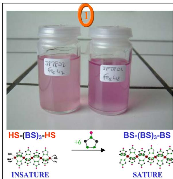
Figure III.15: Cas du pentanucléaire insaturé et saturé – Coloration.
