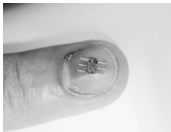
Figure I.15 Micro-robot à six pattes développé à Besançon, l'un des cinq au monde et peut-être le plus petit [LAB03].
