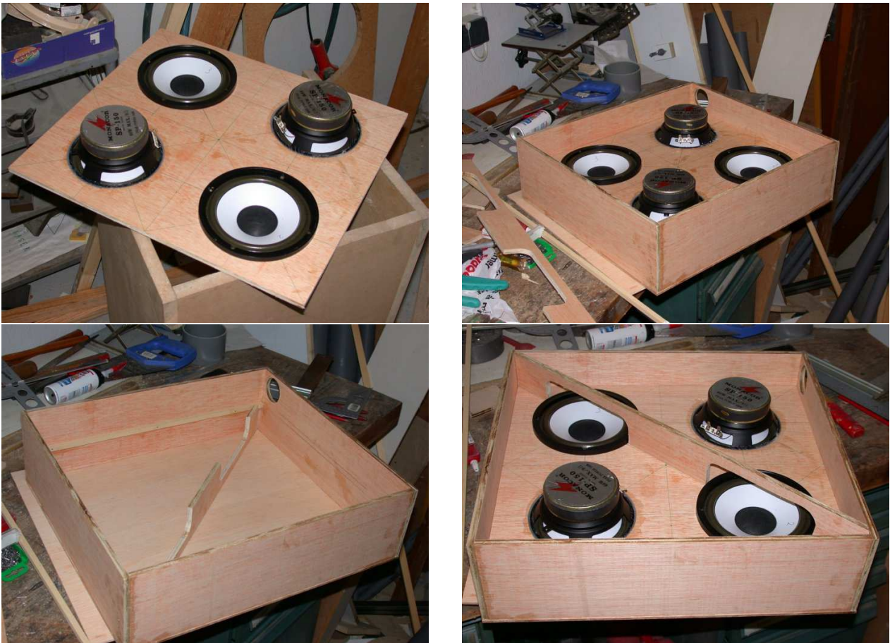
Fig. 3.13 : Vues de la fabrication du prototype du caisson de basses.
