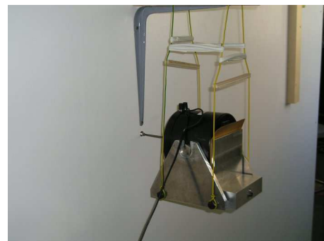
Fig. 3.3 : Vue du montage du pot vibrant.
