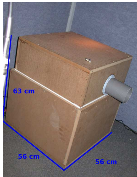
Fig. 5.2 : Vue de la source secondaire destinée au contrôle de la raie à 22 Hz sur l'EC225.
