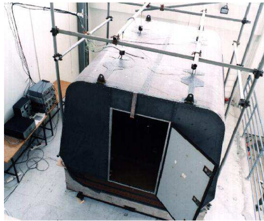
Fig. 1.8 : Vue du tronçon VASCO et des 4 pots vibrants d'excitation. (Photo tirée du rapport de l'ONERA)
