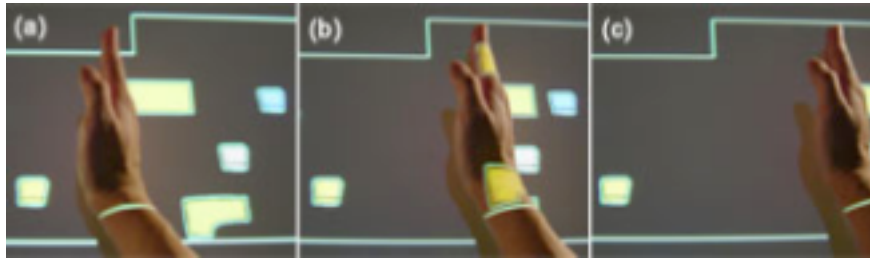
Figure 25 : « sweeping vertical » pour déplacer un groupe d'objets. Illustration extraite de [Wu 03].
