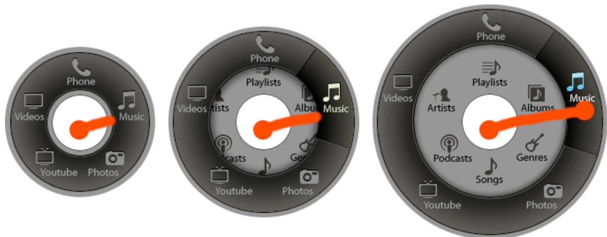
Figure 28 : Wavelet menu : amélioration du Wave menu pour l'aspect apprentissage de la technique. La représentation est basée sur une métaphore de pile.
