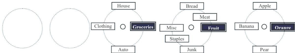
Figure 19 : Un Compound Marking menu à 3 niveaux occupe trois fois l'espace horizontal qu'un menu linéaire.
