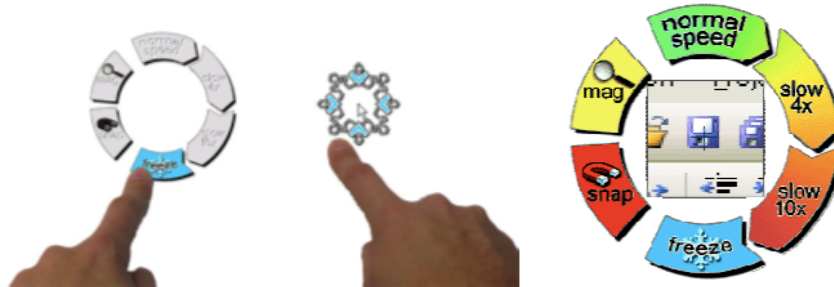
Figure 27 : « Dual Finger X-Menu [Benko 06]. Le menu circulaire est activé dès que deux doigts sont posés sur la table. Illustration extraite de [Benko 06].
