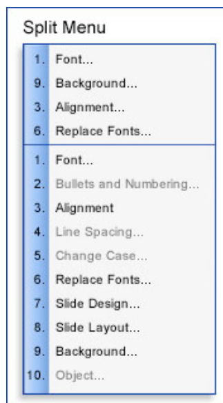
Figure 6 : Les Split menus [Sears 94]. Les items les plus fréquents sont dupliqués et positionnés en haut du menu. Illustration extraite de [Sears 94]
