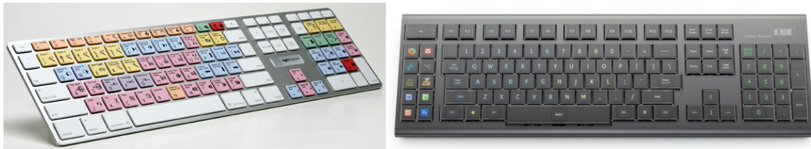
Figure 26 : A gauche, le clavier Logickeyboard adapté pour le logiciel Final Cut [Logickeyboard]. A droite, le clavier Optimus [Optimus] où chaque touche est un petit écran.
