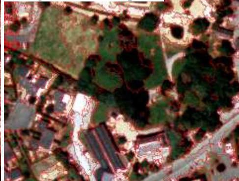
Figure 8 : Etapes de segmentation (A et B) et classification (C) d'une image. Sur A et B, les contours rouges représentent les limites des objets, sur C les limites des objets classés en espaces arborés.
