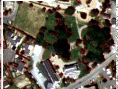
Figure 8 : Etapes de segmentation (A et B) et classification (C) d'une image. Sur A et B, les contours rouges représentent les limites des objets, sur C les limites des objets classés en espaces arborés.
