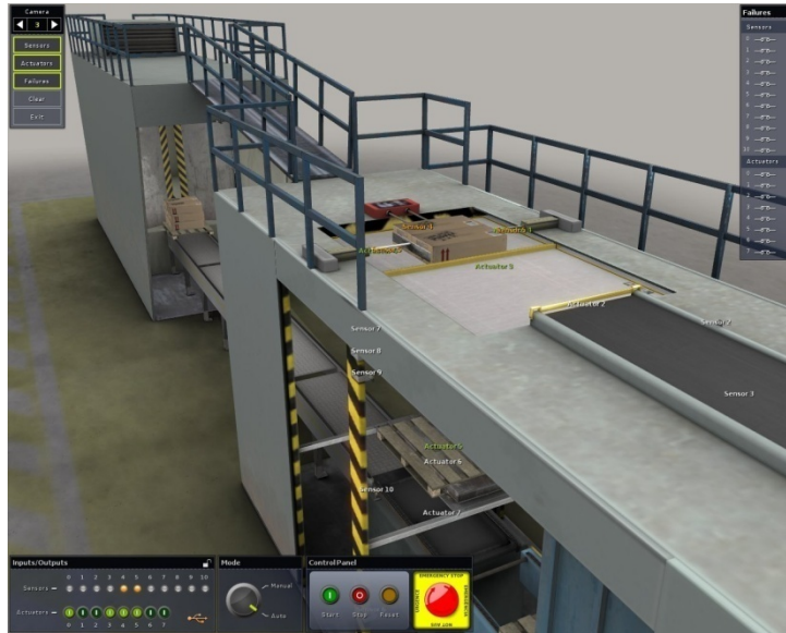
Figure 4 : représentation graphique du palettiseur dans ITS PLC
