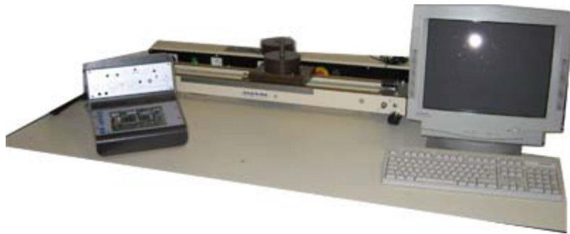
Figure 4 30 : banc Emericc représentant un chariot en translation
