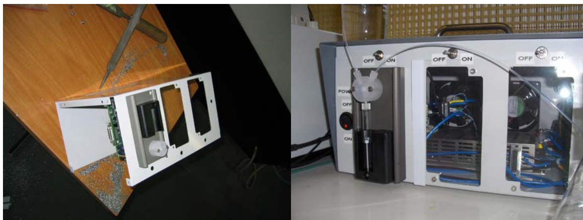
Figure II-5 : Pompes (burettes) XE 1000 (TECAN) munies de seringues de 100 ou 500 \mu l utilisées pour les ajouts en mode logarithmique en voltamétrie
