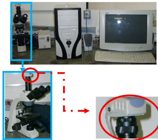
Figura 12. Demonstração esquemática do sistema de visualização e captura através de microscópio óptico (MOTICA BA200) com câmera acoplada (MOTICAM 1000) interligados ao computador.
