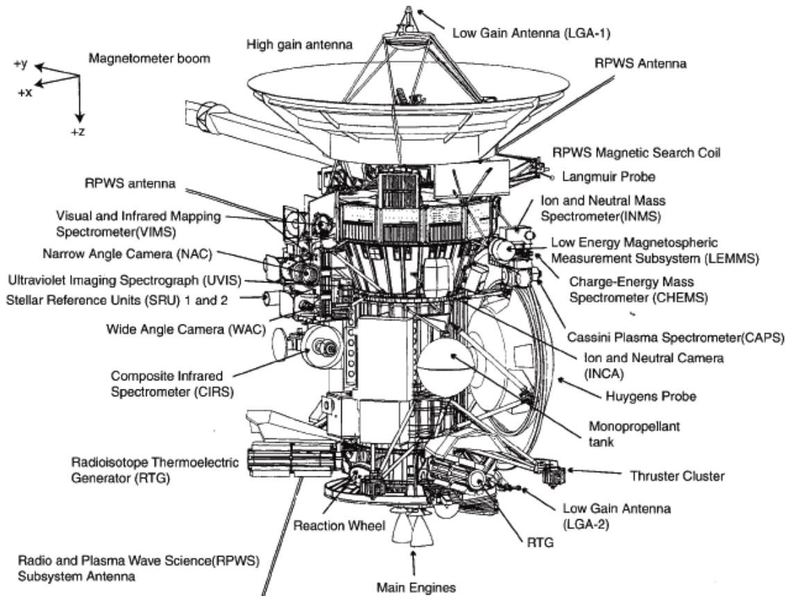
FIG. 1.22 – La sonde Cassini et les instruments plasma à bord de la sonde dans le repère  $(x,y,z)$  de la sonde (description dans le texte). L'axe  $z$  est dirigé positivement anti-parallèlement à l'antenne.
