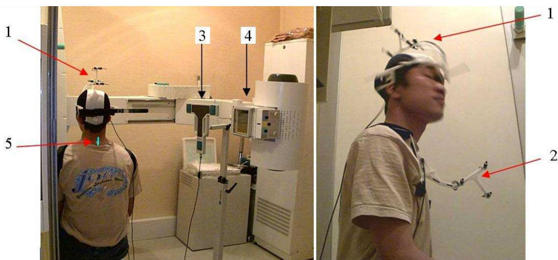
Figure 2.1: Installation du sujet (1: Marqueurs de la tête; 2: Marqueurs du thorax ; 3: Emetteur d'ultrason Zébris; 4: Matériel de radiographie; 5: Mesure de 5 cm).
