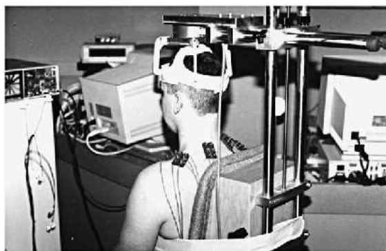
Figure 1.24a: Protocole d'essai in-vivo de chargement du rachis cervical ( Gabriel, 2002 )
