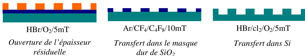
Figure.3: Représentation schématique des procédés de nanoimpression (a) et du transfert par RIE (b).
