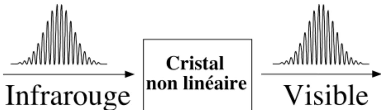
**Figure 38** : Modélisation schématique de la conversion de fréquence pour obtenir des impulsions bi-fréquences dans le visible.
